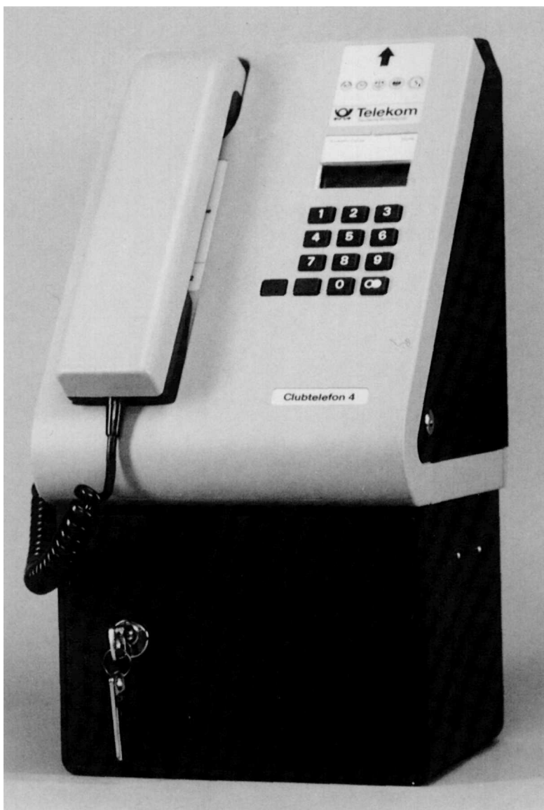
Bild 1: Clubtelefon 4 als Wandgerät mit Metallgehäuse für großen Münz- behälter (Foto: Prüf- und Meßlabor IZ Maisch)
